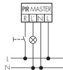
La lumière peut être allumée ou éteinte manuellement en fonction des besoins par un appui court sur le bouton poussoir (Attention: les boutons poussoir lumineux sans neutre ne peuvent pas être gérés).
