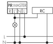
En cas d'enclenchement d'inductances parallèles au réseau (lampes fluorescentes, relais, etc.), un circuit RC peut être nécessaire.
