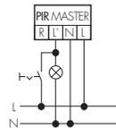
Permet l'allumage manuel de l'éclairage raccordé. Attention: la lumière doit ensuite être éteinte manuellement.
